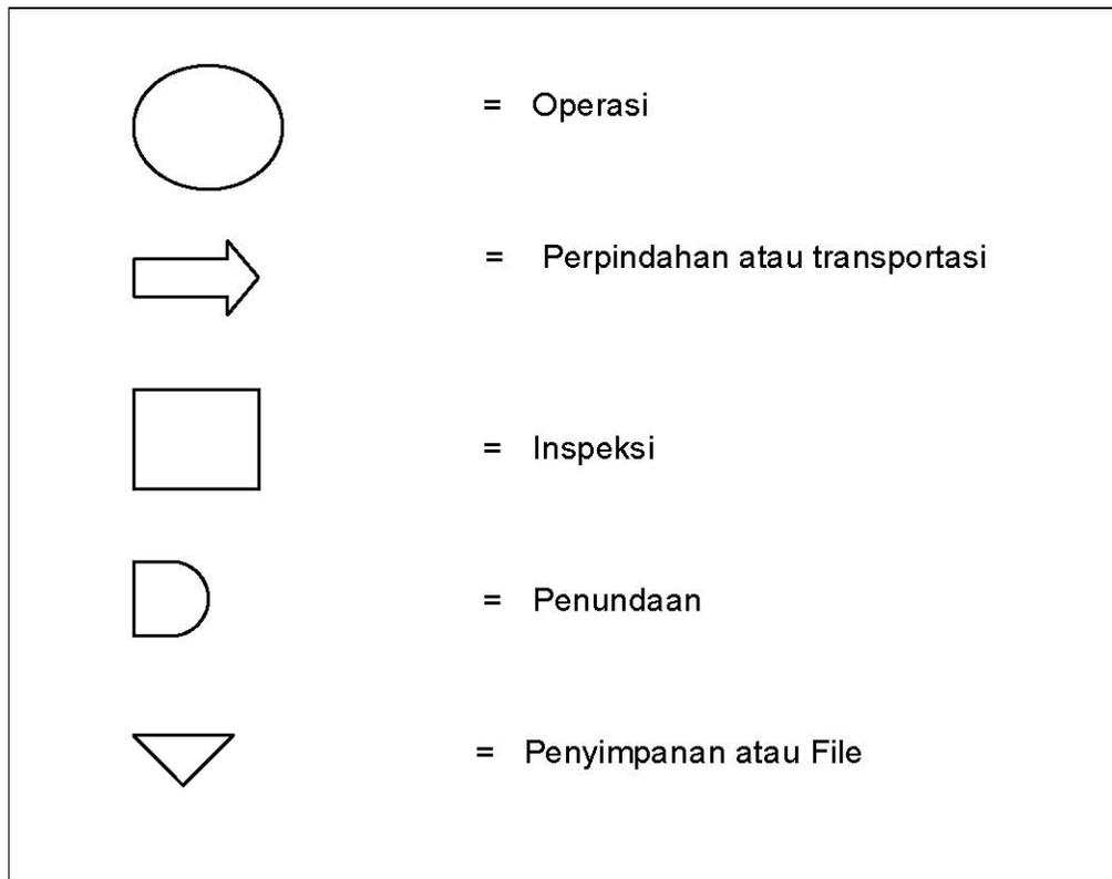
Flowchart Proses digunakan oleh perekayasa industrial dalam mempelajari dan mengembangkan proses-proses manufacturing. Dalam analisis sistem, flowchart ini digunakan secara efektif untuk menelusuri alur suatu laporan atau form. Gambar dibawah ini menggambarkan suatu contoh flowchart proses.
